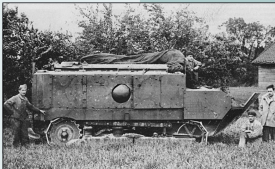
▼ Een van de laatste uitvoeringen van de Schneider. Uit de smalle pantserplaten achteraan de romp blijkt dat de brandstoftanks naar achteren zijn verplaatst.
