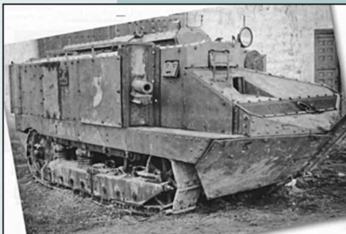
▼ een Carro de Artilleria Schneider CA1 van het Spaanse leger. Nummer 5 van de 6 geleverde tanks. De bescherming van het kanon was gewijzigd en in de boeg was een opening gemaakt waarin een mitrailleur kon worden geplaatst.
