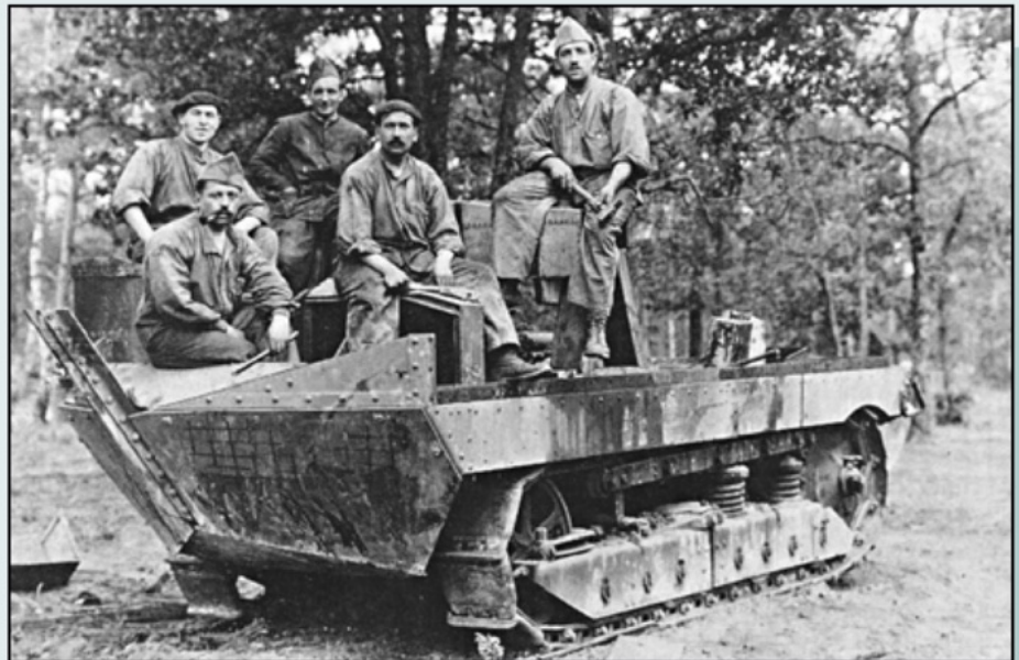
▲ De eerste afgeleverde Schneiders waren bestemd voor de opleiding van de bestuurders, ze hadden dan ook geen pantsering
