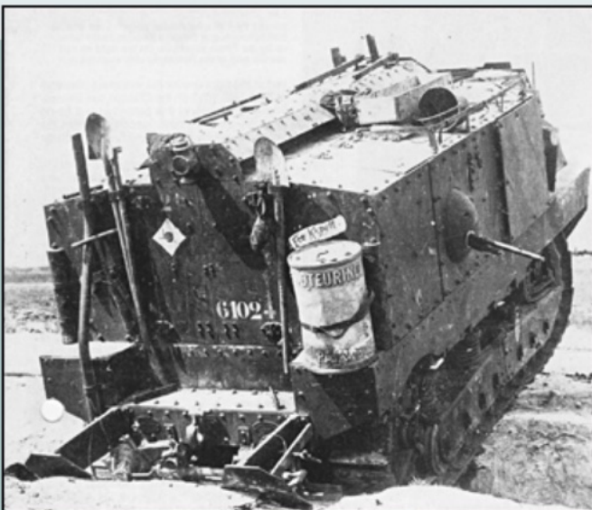
▲ Een goed beeld van de achterkant van de Schneider. De achterdeur bestaat uit twee delen, aan de zijkanten zijn extra pantserplaten aangebracht.
